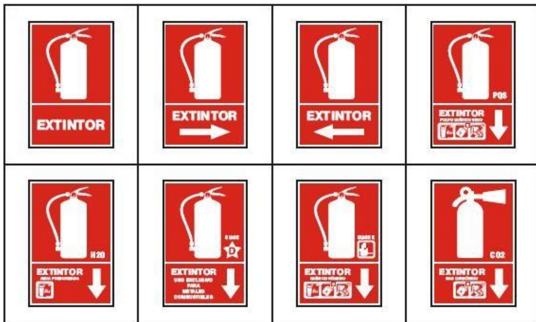
FIGURA 5 – Carteles varios con las señales para indicar la ubicación del extintor
